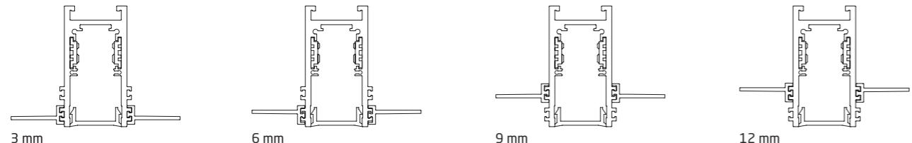
Konstrukcja szynoprzewodów umożliwia dostosowanie wysokości skrzydełek do różnych grubości płyt gipsowo-kartonowych.
